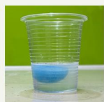
直接放入將冷凍後的 乳酸鈣溶液浸泡 於海藻酸鈉溶液
