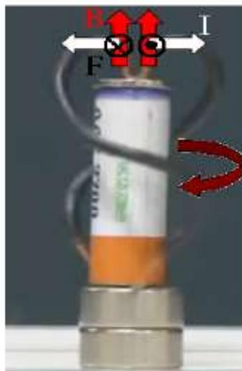
圖 1：電磁交互作用產生的羅倫茲力示意圖
